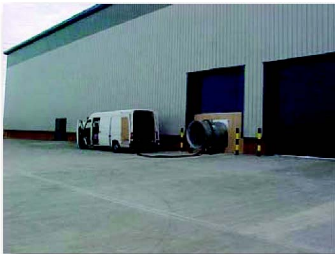
Air Tightness Test - MIDI fan
